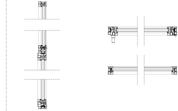
SECCIÓN VERTICAL Y HORIZONTAL CARPINTERÍAS EXTERIORES E-1/10
